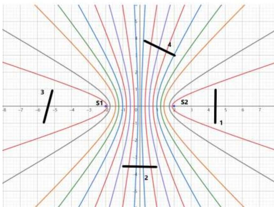
等光程面（等光强面）如图所示。图中 $S_1$ 和 $S_2$ 为两个虚光源，它们的连线为 $X$ 轴，与它们的连线垂直的轴为 $Z$ 轴；
