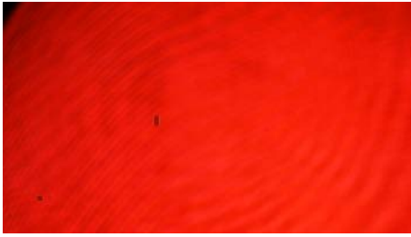
图 57: 二维光栅小孔滤波 (只过 0 级)
